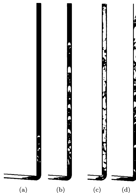
图 8 Case D 液气喷发阶段立管内气液混合流动变化过程
