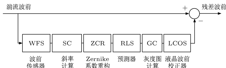
图 1 带有 RLS 预测功能的开环液晶自适应光学系统框图
