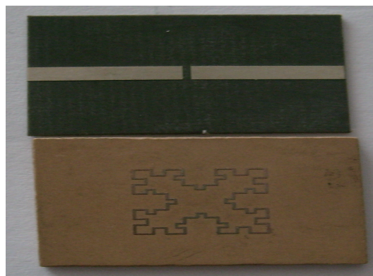
图 11 一单元结构双频带滤波器部件图
