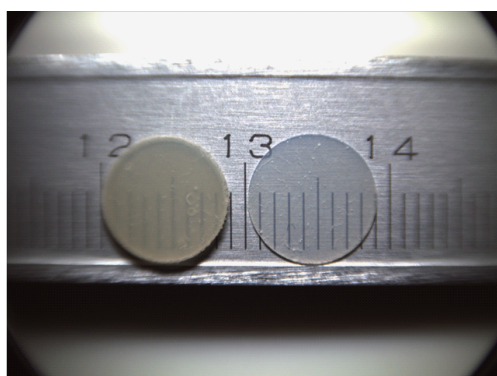
图4 BSN-KNN 透明陶瓷的样品实物图
