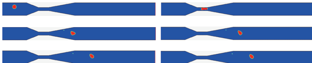
图7 激光空泡的运动过程的数值模拟 ( P_1 = 25 kPa)
