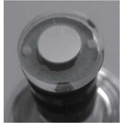
图5 激光内雕赋值频差的双频激光器
