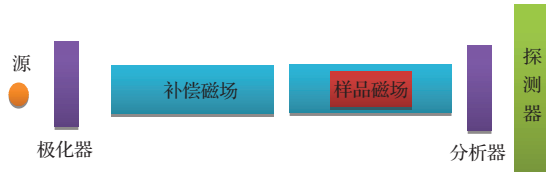
图2 基于自旋回波法的极化中子成像系统
