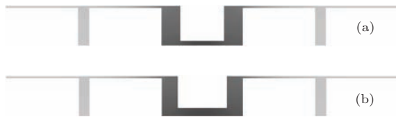
图6 两种目标下的复杂肋片最优构形比较 (a) 当量热阻最小的肋片最优构形; (b) 最大热阻最小的肋片最优构形
