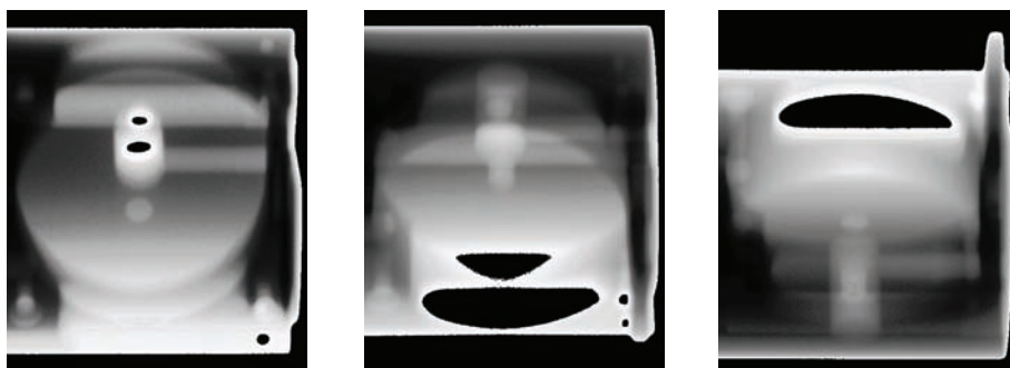
图 4 复杂结构件 20^\circ 、 110^\circ 及 210^\circ 高动态投影数据
