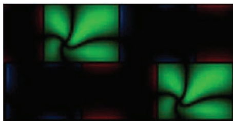
图3 (网刊彩色)应用三维光学模型模拟所得的VAN CF-LCoS微显示器件的彩色像素阵列图像
