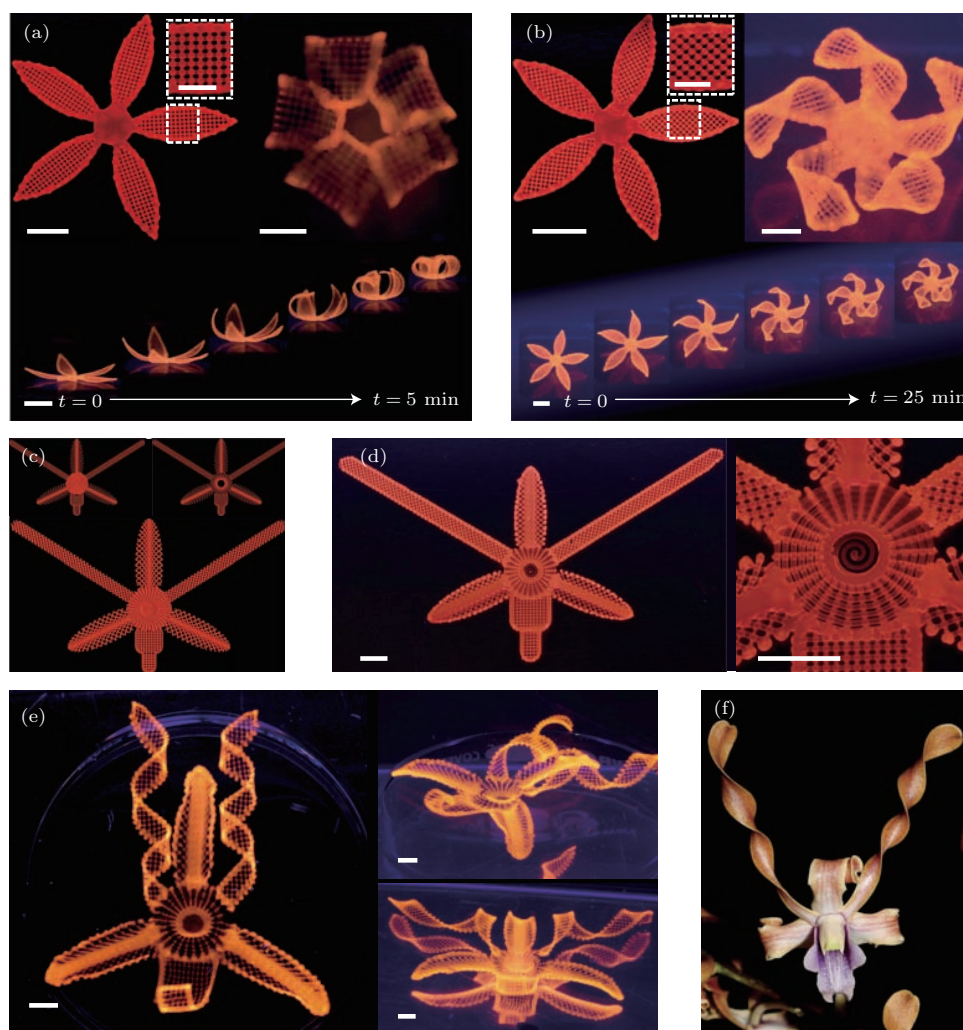
图8 用4D生物打印技术制作复杂花朵形态 (a), (b) 简单的花朵可由 90^\circ , 0^\circ , -45^\circ 和 45^\circ 纤维构成; 在花瓣变形过程中, 双分子层控制每片花瓣的弯曲方向(比例尺: 5 mm, 插入图为2.5 mm); (c) 打印的结构; (d) 使结构膨胀; (e) 花状结构呈现出一系列有天然兰花的形态结构; (f) 经过此打印过程, 此兰花结构展示了四种不同的形态: 弯曲、扭曲、花冠周围的褶皱和中央区域的漏斗形状(比例尺: 5 mm) [36]
