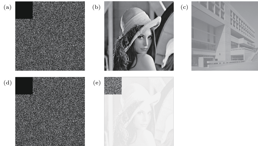
图9 使用 Q-plate 做偏振加密和传统偏振加密比较 (a) 用 Q-plate 做偏振加密, 信息丢失 6.25% 的密文图; (b), (c) 用 Q-plate 做偏振加密, 密文信息丢失 6.25% 的解密图; (d) 传统偏振加密, 信息丢失 6.25% 的密文图; (e) 传统偏振加密, 信息丢失 6.25% 的解密图
