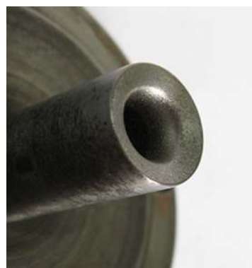
图 9 实验后的内磁极刻蚀形貌图
