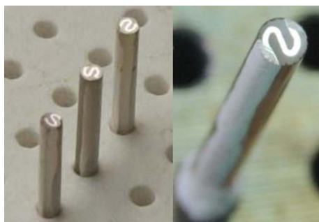
图 1 \Phi 2 mm 柱状热流传感器
