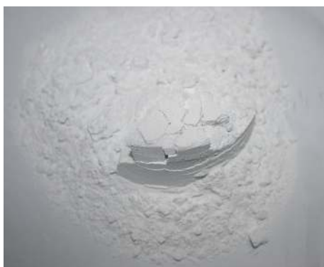
图 8 集粉箱内的粉末压实现象
