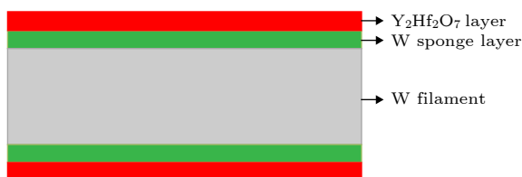
图 1 磁控管用新型钪酸铪陶瓷阴极剖面结构示意图 Fig. 1. Section schematic of the Y_2Hf_2O_7 ceramic cathode.
