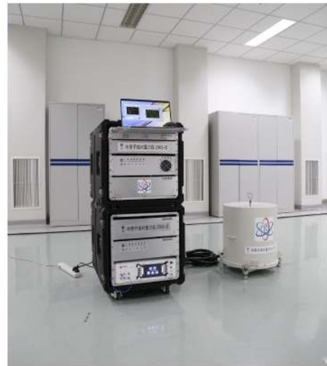
图 1 原子重力仪实验装置的照片
