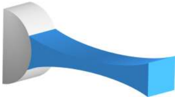
图1 柱透镜产生光片示意图 Fig. 1. Schematic diagram of the cylindrical lens.
