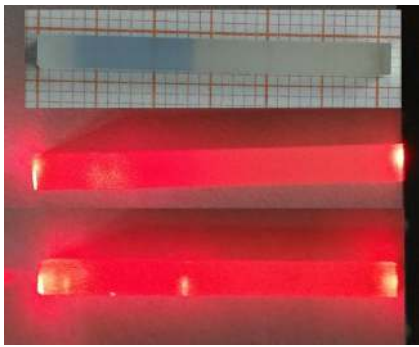
图 2 双端键合 YVO 4 /Nd:YVO 4 /YVO 4 晶体照片 (上方两个晶体图片是本实验所用的同一块晶体, 下方的晶体图片是另一块键合面散射严重的键合晶体)
