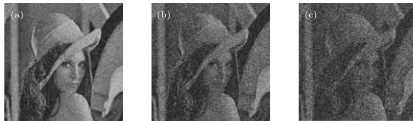
图 16 加密图像数据随机丢失的解密图像 (a) 随机丢失 10%; (b) 随机丢失 30%; (c) 随机丢失 40%
