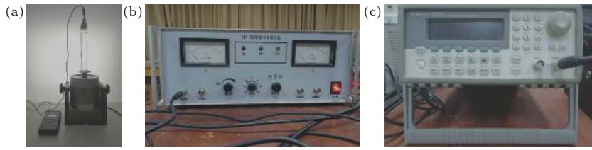
图 5 实验仪器 (a) 振动台和瓶子; (b) 功率放大器; (c) 信号示波器
