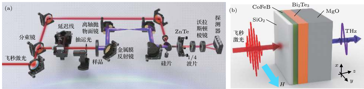
图 1 (a) 实验装置示意图; (b) \text{Bi}_2\text{Te}_3(4)/\text{CoFeB}(2) 异质结的结构示意图
