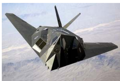
图 1 吸波或定向散射隐身, 美国空军 F117A 隐身战机的独特外观可以针对单基站雷达系统有效隐身
