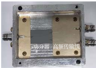
图 7 超导微波功分器实物图, 器件尺寸为 18 mm \times 12 mm
