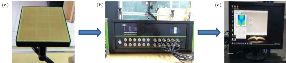
图 5 (a) 传感器单元; (b) 数据采集单元; (c) 图像重建单元实物图
