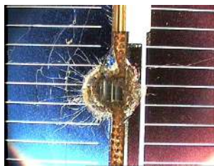
图 12 哈勃望远镜太阳能电池阵电池面超高速撞击穿孔形貌 [1,6]
