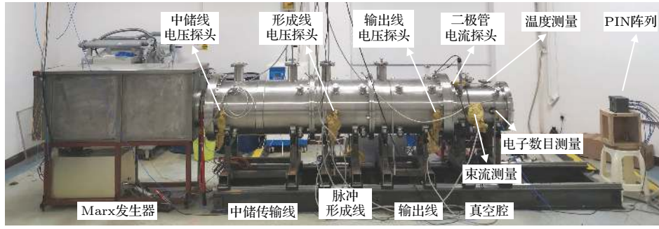
图 11 系统总体结构和测量探头布局
