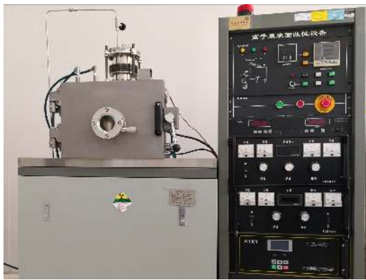
图 2 离子束表面改性专用设备图 Fig. 2. Photo of ion-texturing apparatus.
