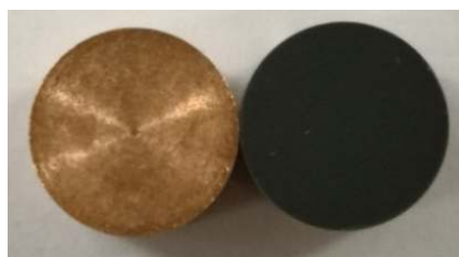
图 4 无氧铜光电阴极基体表面处理前后的照片
