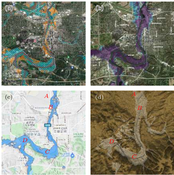
图 12 爱荷华场景水淹情况示意图 (a) 依据历年水淹范围统计的淹没概率图; (b) 2008 年 6 月爱荷华雨洪淹没范围图; (c) 水深 25 ft, 流量 31200 cfs 情况下淹没范围图; (d) 本文淹没模拟结果示意图
