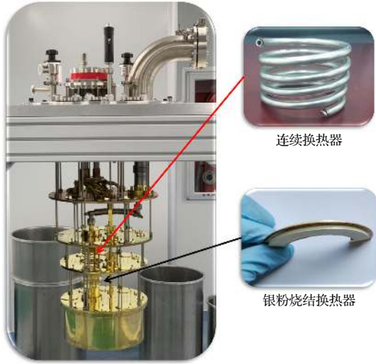
图 3 超低温稀释制冷机系统及其关键换热部件: 连续换热器和银粉烧结换热器 (图片由南方科技大学量子科学与工程研究院提供)
