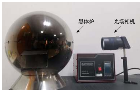
图 8 光场相机辐射强度标定实验装置图
