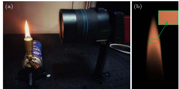
图 11 燃烧火焰实验图 (a) 实验装置; (b) 丁烷火焰辐射光场
