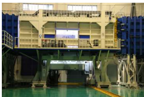
图 3 FL-51 风洞闭口试验段 Fig. 3. The closure test of FL-51 wind tunnel.
