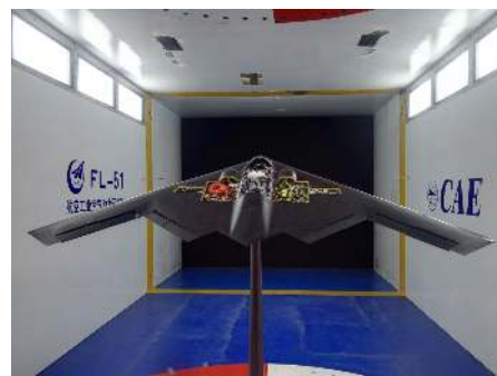
图 5 等离子体电源和飞翼模型安装
