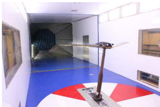
图 6 风洞试验段的等离子体控制飞翼模型
