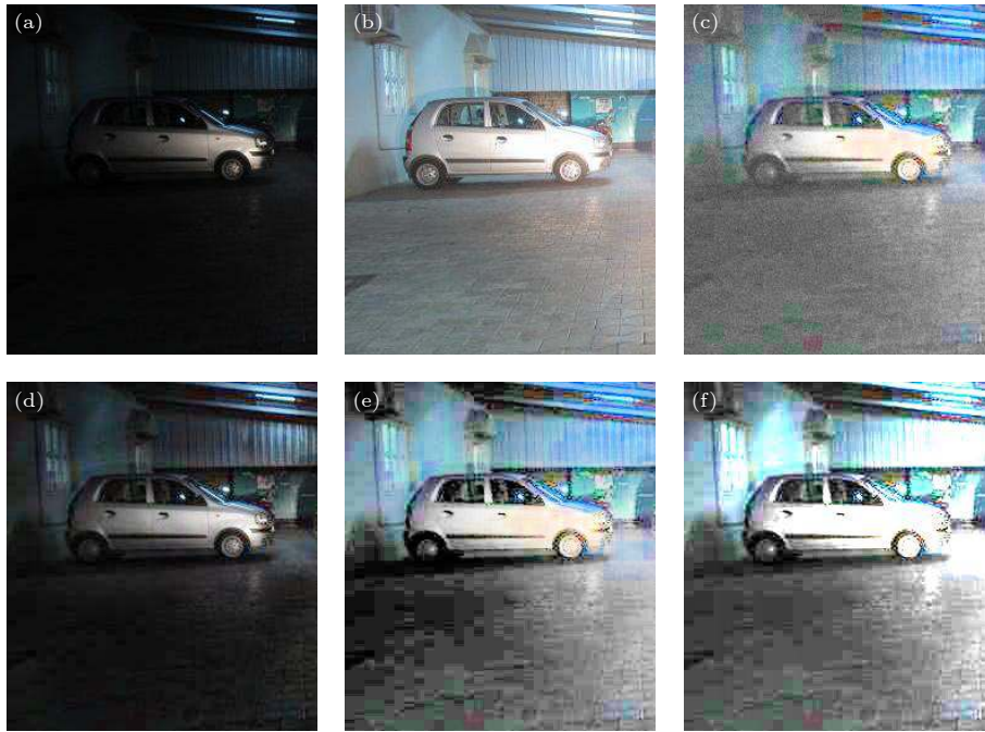
图 9 图像增强结果 (a) 原始黑暗图像; (b) 原始清晰图像; (c) 本文提出的随机共振方法, D = 0.0035 , V_{th} = 0.0667 ; (d) SSR 算法; (e) HE 算法; (f) SVD-DSR 算法
