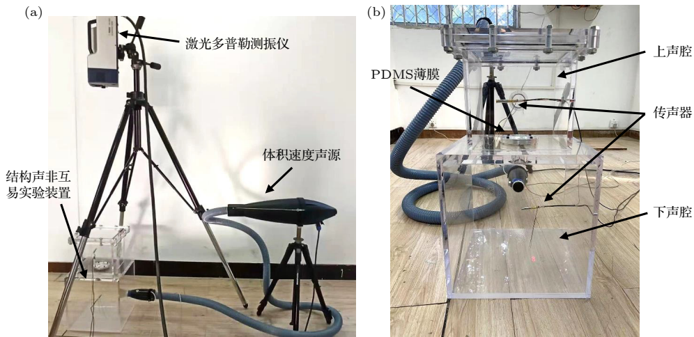
图 1 结构声非互易系统构成 (a) 实验系统全貌; (b) 非互易实验装置
