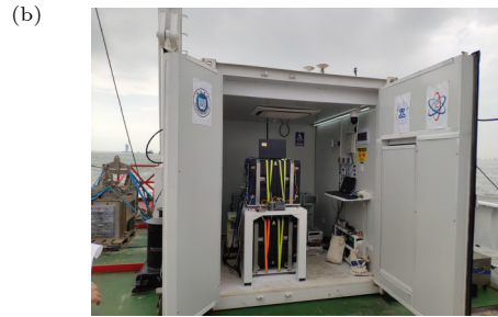
图 3 可移动的原子重力仪实验室 (a) 实验室内部仪器设备布局示意图; (b) 可移动实验室实物图
