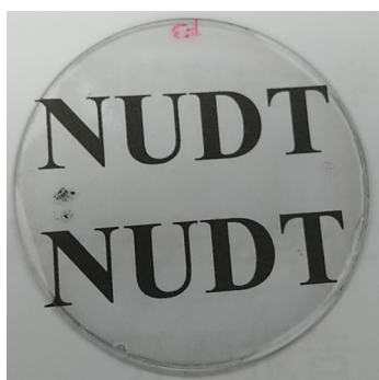
图 4 金属网格透明导电薄膜样品图 Fig. 4. Diagram of metal mesh transparent conductive film.
