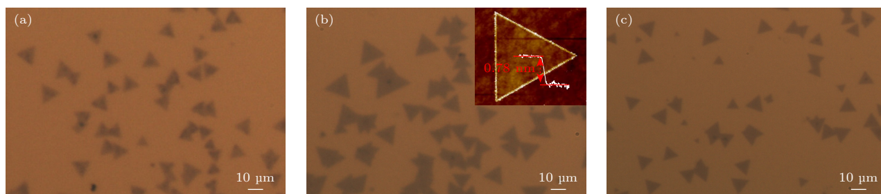
图 2 不同生长时间下的 \text{MoS}_2 光学显微镜图像 (a) 10 min; (b) 15 min, 内插图为单个 \text{MoS}_2 的 AFM 图; (c) 20 min
