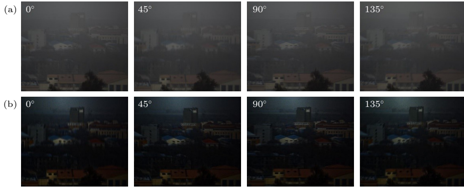
图 6 除雾前后各偏振通道图像 (a) 原始各偏振通道图像; (b) 去雾后各偏振通道图像
