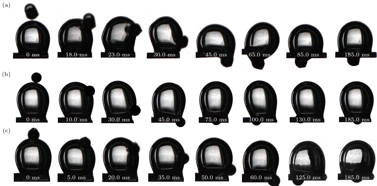
图 4 Janus 颗粒与气泡的相互作用动态过程 (a) 亲水侧接触气泡; (b) 超疏水侧接触气泡; (c) 分界面接触气泡
