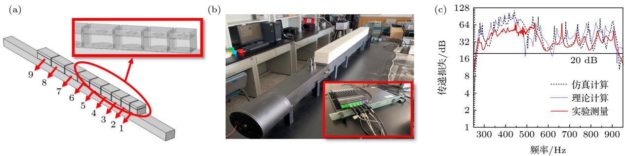
图 6 (a) 由 9 个二阶共鸣器单元组成的抗性消声器仿真模型; (b) 实验测试图; (c) 实验测量与 Comsol Multiphysics 仿真、Matlab 计算结果的传递损失对比图
