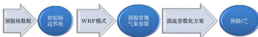
图 3 中尺度气象模式预报 C_n^2 流程图
