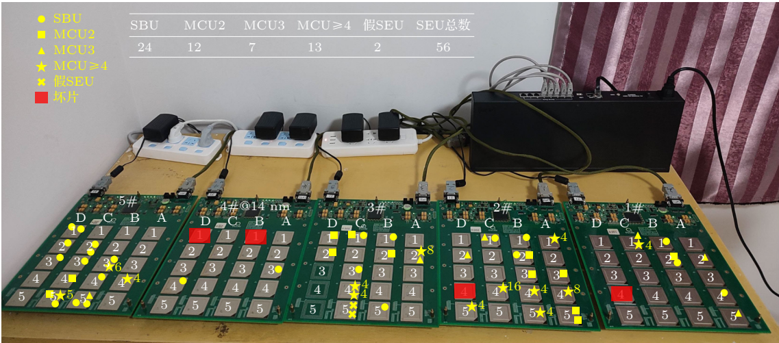
图 2 试验现场图及测试结果
