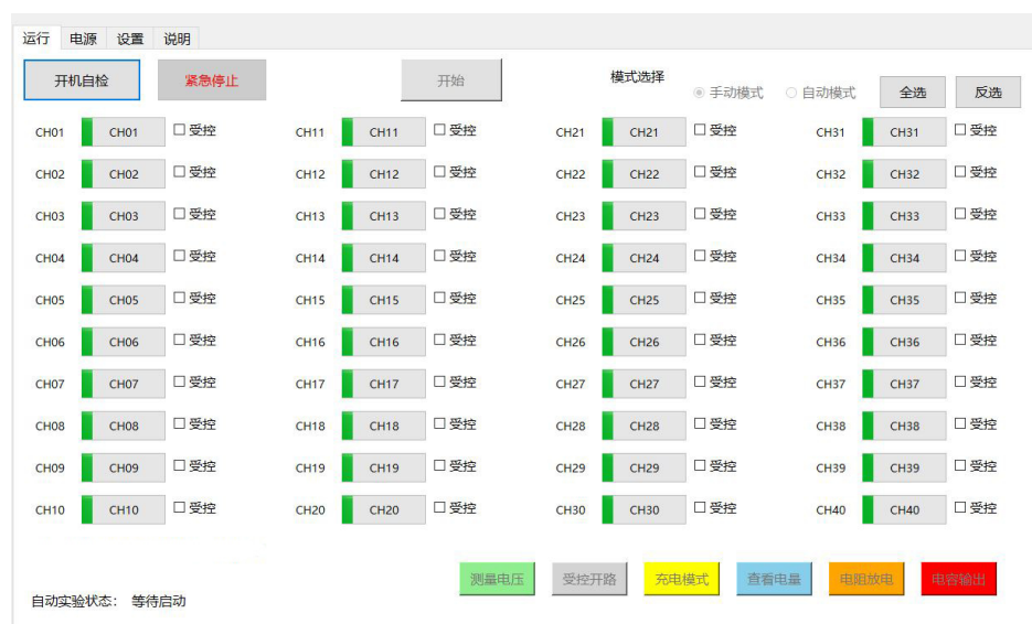
图 4 电容充放电控制软件的运行界面
