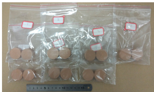
图 1 14 个不同 \text{ZrSiO}_4 添加量混合红外诱饵剂药柱样品实物图
