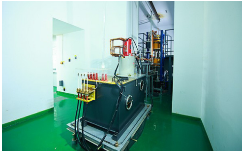
图 13 10 MeV 高能电子直线加速器
