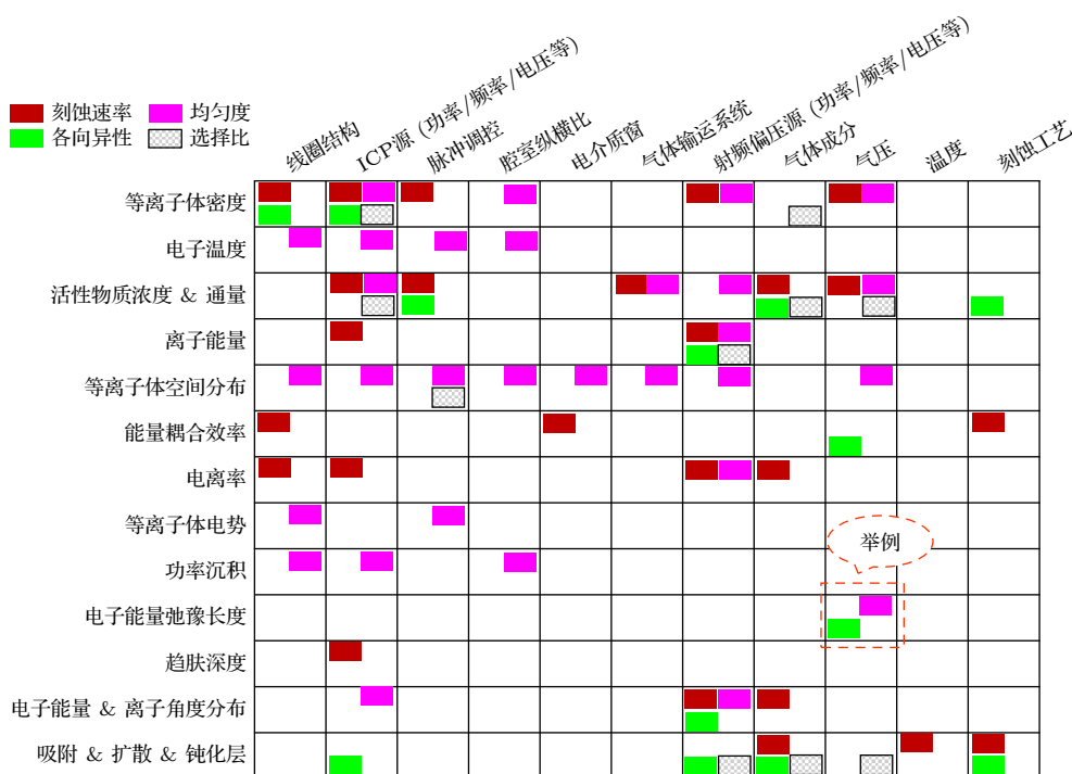
图 18 “工艺参数-等离子体特征-刻蚀性能”之间的典型调控关系
