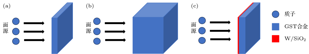
图 1 质子入射靶材示意图 (a) 薄靶模型; (b) 等射程模型; (c) 添加屏蔽层的薄靶模型
