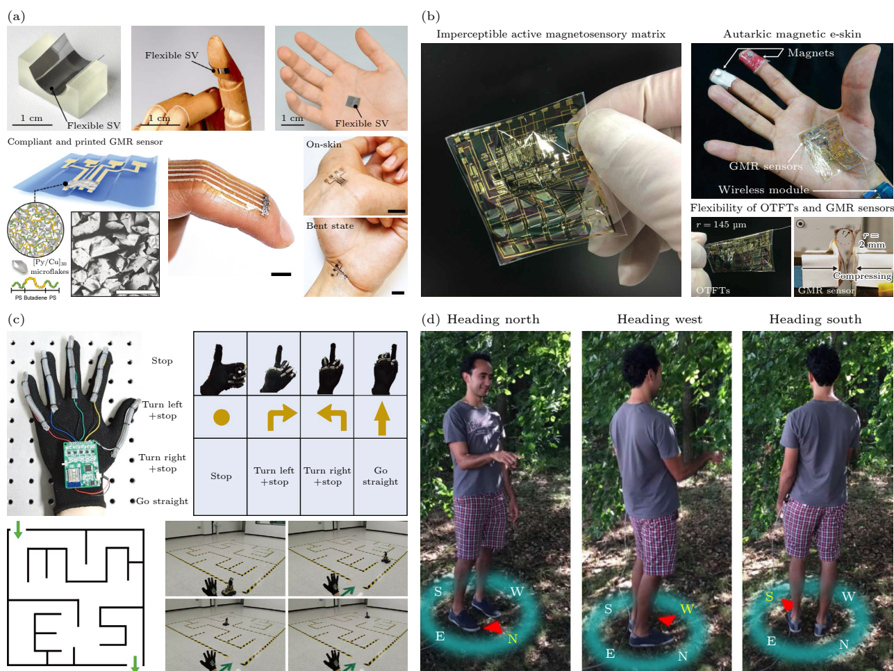
图 7 柔性磁传感器用于制造磁敏电子皮肤 (a) 3D 打印制造的可贴附磁敏电子皮肤 [6,21] ; (b) 通过微纳制造构建的单片丙烯酸晶圆电子皮肤用于位置感知 [86] ; (c) 自供电电子皮肤通过人机交互实现运动感知 [12] ; (d) 磁敏电子皮肤感知地磁场实现定位巡航 [24]
