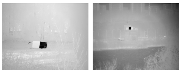
图4 近距离和远距离观测的刃边靶板红外成像图
