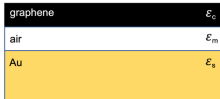
图 S3 单层石墨烯/空气间隙/金多层结构的侧视图
